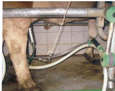
Fig. 5: Vendosje optimale e tubave, por për Simental gota mjeljeje shumë të lehta
